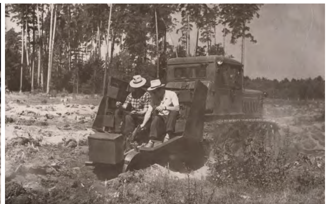
Механізована посадка лісових культур студентами з використанням лісосадильної машини СБН-1, 1964 р.
